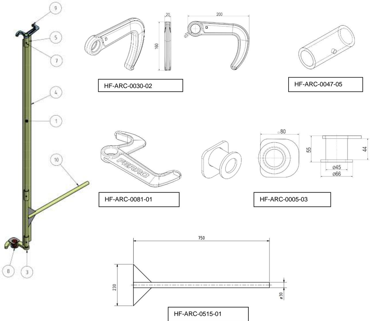
S-Hakenverschluss/ Türverschlussgestänge für lichte Höhe 2300 bestehend aus:
